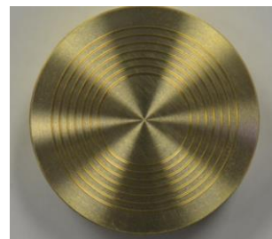
図 10 同心円状の微細 V 形溝を有するワーク
