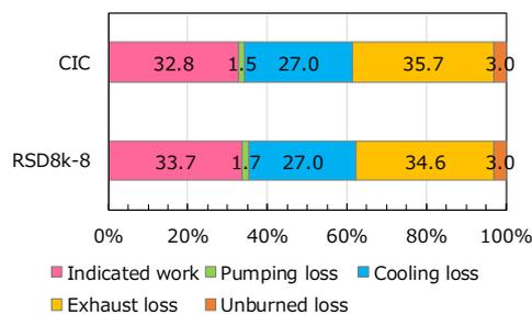
図3 空気過剰率1.6の時の熱収支
