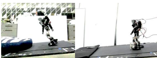
図6 ロック機構を装着しない坂歩行(左)および装着した場合の歩行(右・支柱高さ30mm)(いずれも傾斜角7.5度)。
