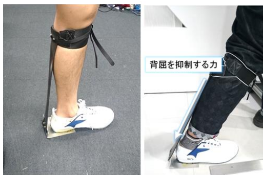
図9 支点切り替えの原理による人の歩行安定化。
