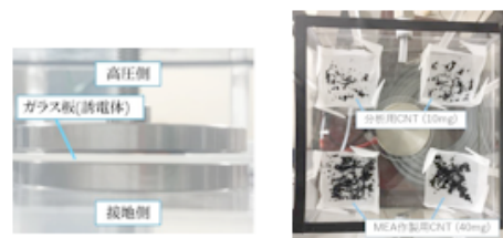
図 1 表面改質用バリア放電リアクタ
