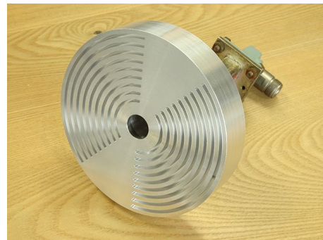
図 作成した金属円盤形表面波分割器
