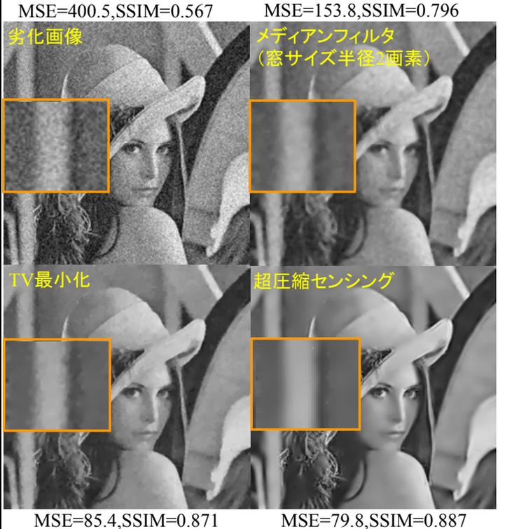
図 1 画像の雑音除去の評価実験結果
