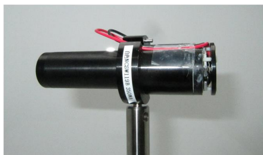
図 3. LED 光源ユニット概要図(上)および試作した光源ユニットの写真(下)
