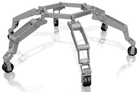
図1 脚車輪型移動ロボット(NASA/JPLのATHLETEをモデルに作成)
