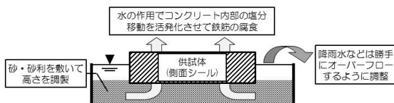
図-4 断面修復箇所の模擬供試体
