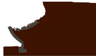
図7 個別要素法と SPH 法の連成解析による最終変形状態
