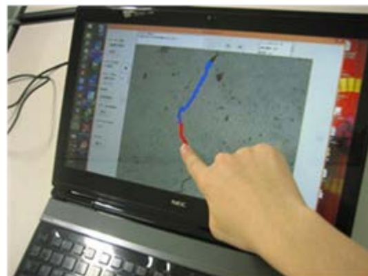
図-2 タッチパネルを利用したひび割れ抽出作業
