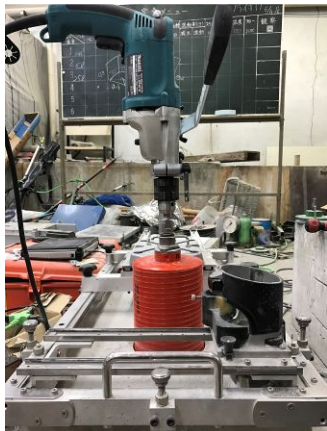
写真-4 乾式ダイヤモンドコアビット取付け状況
