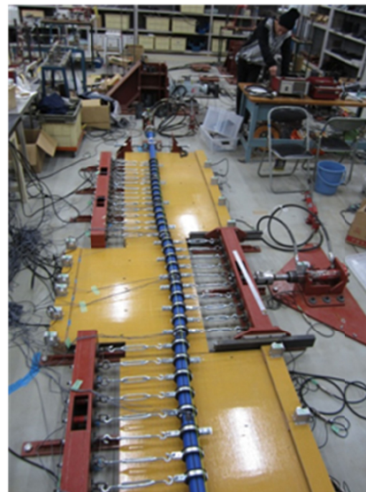
段差変位入力実験装置
