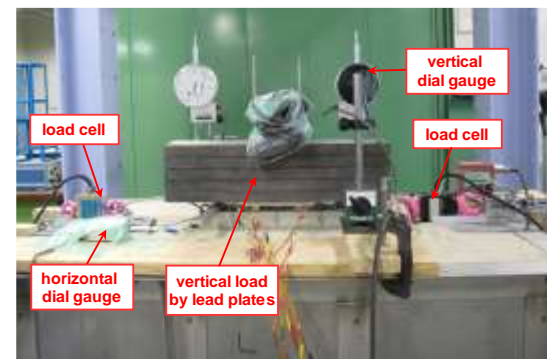
図4 繰り返し水平載荷実験の状況
