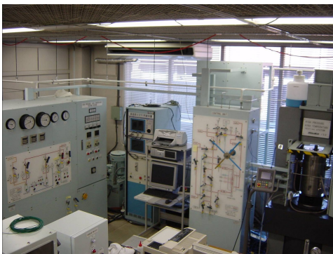
ガス圧式高温高圧実験装置。地下深部で起こっている現象を加速化して検証できる。 (産業技術総合研究所 地質調査総合センター)
