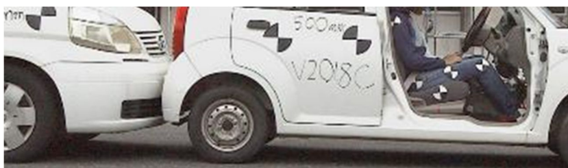
図6. 実車による追突事故の再現と運転者下肢の挙動観察
