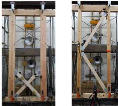
図18 方づえとK形筋かいの試験体
