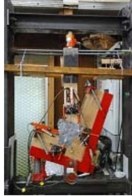
図8 筋かい端部一軸組の接合部引張・圧縮試験
