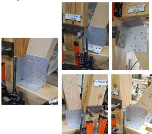
図3 ボックス形筋かい金物の破壊性状
