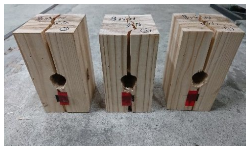
図3 集成材の支圧試験(繊維方向)
