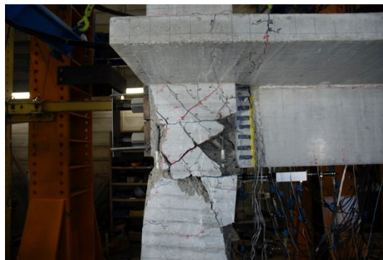
写真 2 スラブを付けたト形柱梁接合部の曲げ降伏破壊
