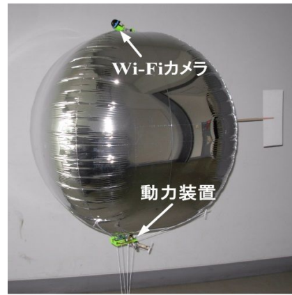
Fig.3 目視検査のための小型無人飛行船
