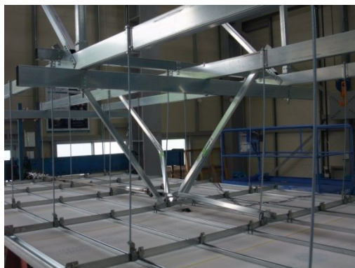
写真5 モデル5の終局状況 (斜め材の座屈)
