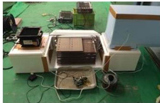
写真 2-1 実験装置と蓄熱体
