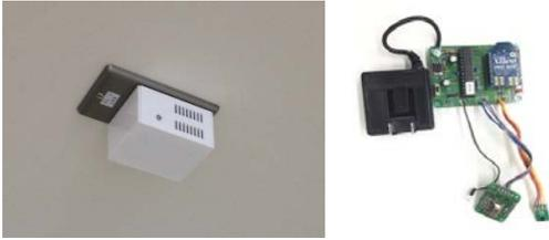
図 2 天井面に設置した子機と内部基盤
