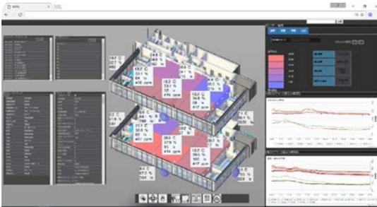
図 4 3D モデル上にセンシングデータを視覚化するウェブシステム
