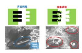
凝集破壊 界面剥離+凝集破壊
