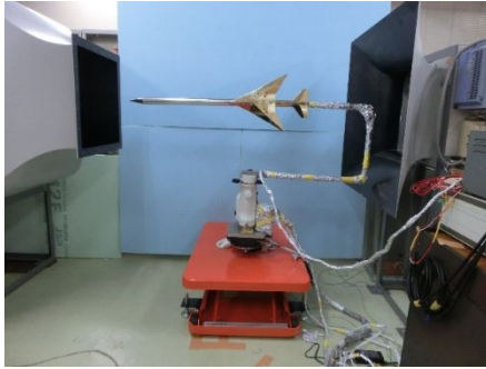
図4．低速風洞に機器を設置した様子
