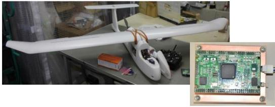
図 5 小型無人機 (先行研究プロトタイプ) と Dyn DGA を実装した FPGA ボード
