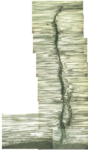
図4 T800H/#3633の0°層のSection-A顕微鏡写真(24kN)
