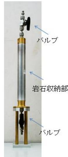
図 1 X 線透過型熱水流動循環圧力容器
