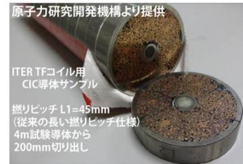
図 7 : 原子力研究開発機構より提供の ITER 用 TF 導体サンプル (導体長さ約 200mm)
