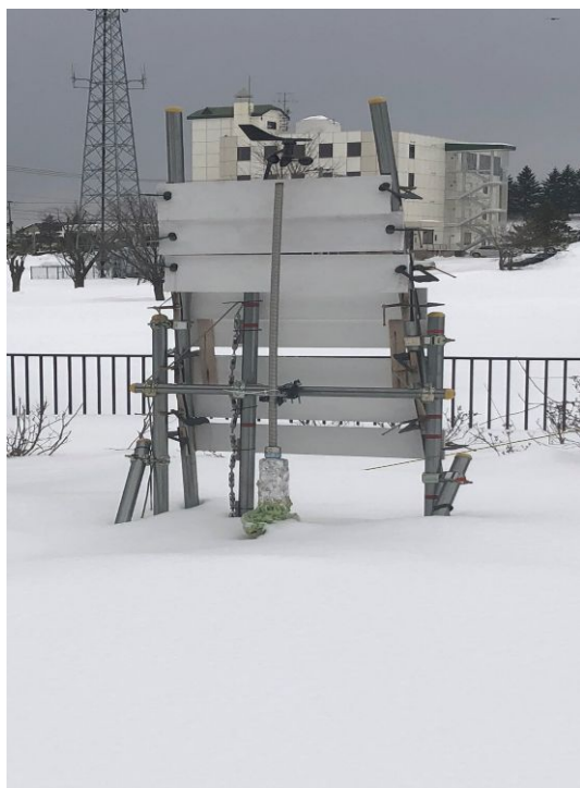
図8 実証実験用の温度差発電システム
