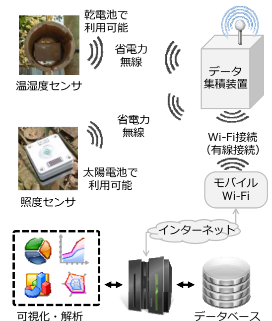
図1 開発した計測システムの構成
