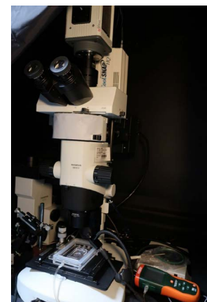
図 1 マクロ顕微鏡を用いた低倍のルミネッセンスイメージングシステム
