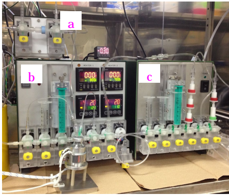
図2. 装置の外観 (a. F-18 イオン精製装置、 b. 標識合成装置、c. 二次反応・精製装置)
