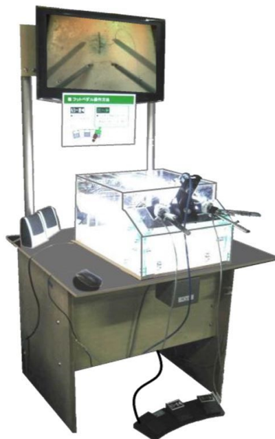
図1 内視鏡下結紮縫合のためのトレーニングシステム「追いトレ」
