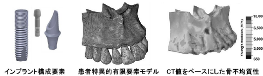
図3 .CTを用いた有限要素モデルの構築および解析
