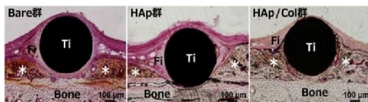
(図2: チタン、HAp、HAp/Col、コーティングロッド、移植4週間後の組織像、HAp/Colコーティングロッド周囲に十分な新生骨の生成を認める)
