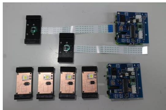
図 2: カメラ (左上) ライト (左下) と Raspberry Pi に実装したタイマー回路。
