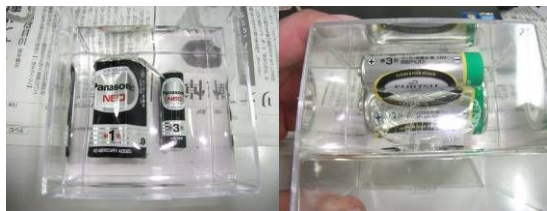
図 7：加圧後の乾電池の様子。金属容器が変形し空隙が発生する。左の電池は、加圧実験直後には液漏れは発生しなかった。右の電池は、加圧実験直後の液漏れも確認された。
