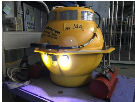
図 9：カメラと温度計を搭載した OBS。
