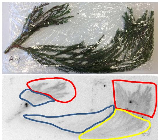
図4 .(上図)スギ樹葉の光学写真像。(下図) オートラジオグラフ像 . 赤線、黄線、青線で囲われた部位ごとに切り分けてセシウム 137 放射能濃度の測定を行った。
