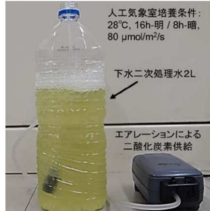
図4 下水二次処理水を栽培水とした Euglena gracilis 培養するリアクター
