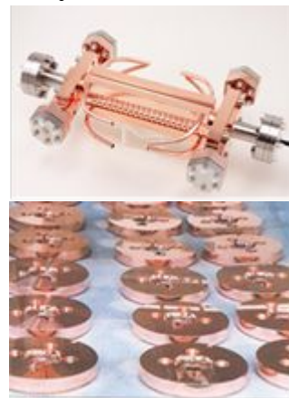
図1 超精密加工を必要とする加速管(上図)とその構成セル(下図)の写真。この加速管は、医療用加速器開発を目的とした加速管である。
