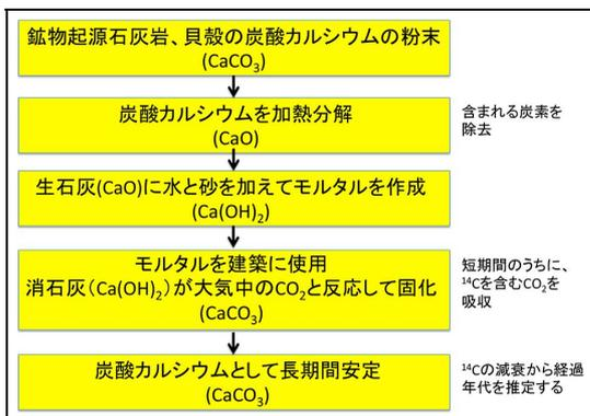
図2 モルタルを用いる<sup>14</sup>C年代測定の原理
