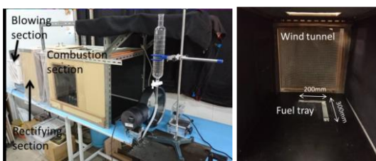
図6 改良後の小型火災風洞（上：模式図，下：全体写真および内部の燃料配置）
