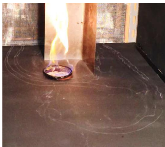
図8 試験的に発生させた障害物背後の渦構造と火災旋風
