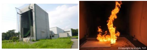
図1 建築研究所の火災風洞(左)および数m級の火災旋風(右)
