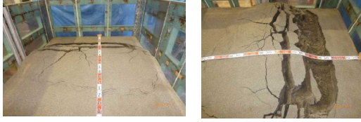
図4 実験後の地表面の状況
