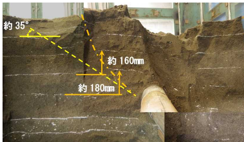
図5 実験後の管の中央断面の地盤変状
