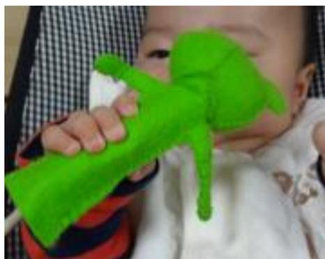
図5 乳児がDataGripを内蔵したぬいぐるみを介する握力計測システムを使用している様子
