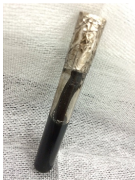
図 7 ステージ 1 黒鉛層間化合物を P 2228 TFSA 中で 350°C で加熱したもの
