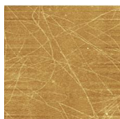
図4：②型ペプチド のAFM像（一辺5μm）、 直径数nmのファイバー が観測された。
