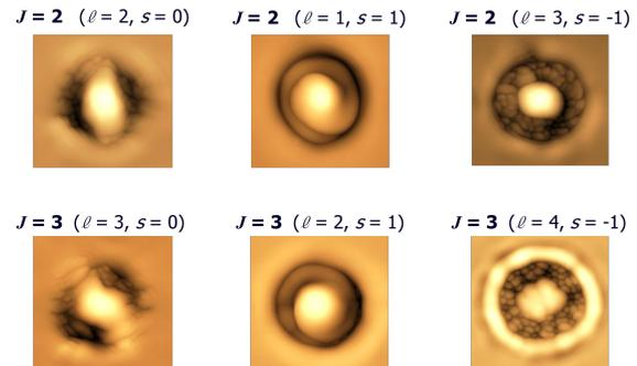
図1 全角運動量における縮退の破れ。軌道角運動量とスピン角運動量が同符号の時だけカイラル表面レリーフができる。
