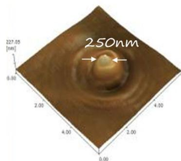
図4 カイラル表面レリーフが創る近接場によって誘起されたアゾポリマーの質量移動。右回り円偏光を照射することで、アゾポリマーがカイラルな表面レリーフに変形。表面レリーフの大きさは照射したレーザー波長の半分の大きさで近接場がナノスケールの質量移動を誘起したことを示す。
