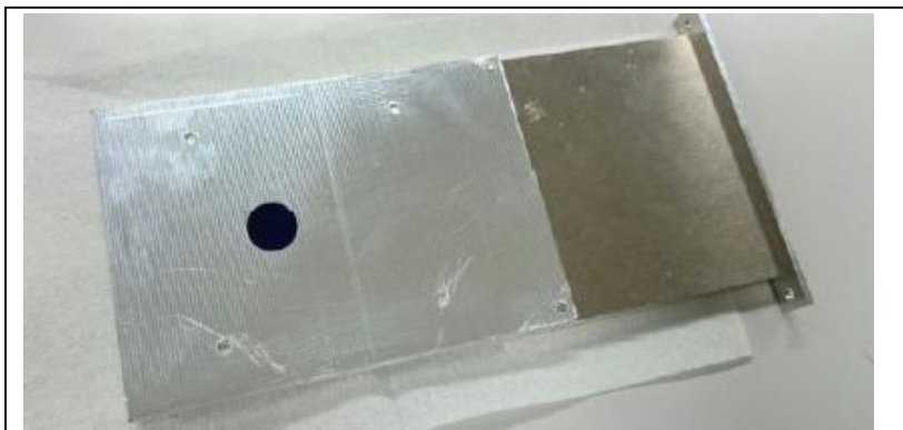
図1 製作した専用マスクカセットに入れた部分減光フィルタ
