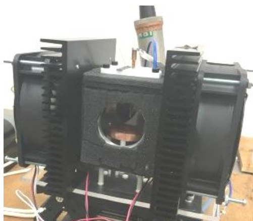
図2：実際の放電リアクタの外観
