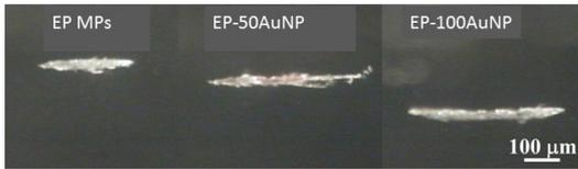
図5 エポキシ粒子および 50 nm、100 nm の AuNP をそれぞれ表面結合したエポキシ粒子の音場-重力複合場内での凝集、浮揚の様子
